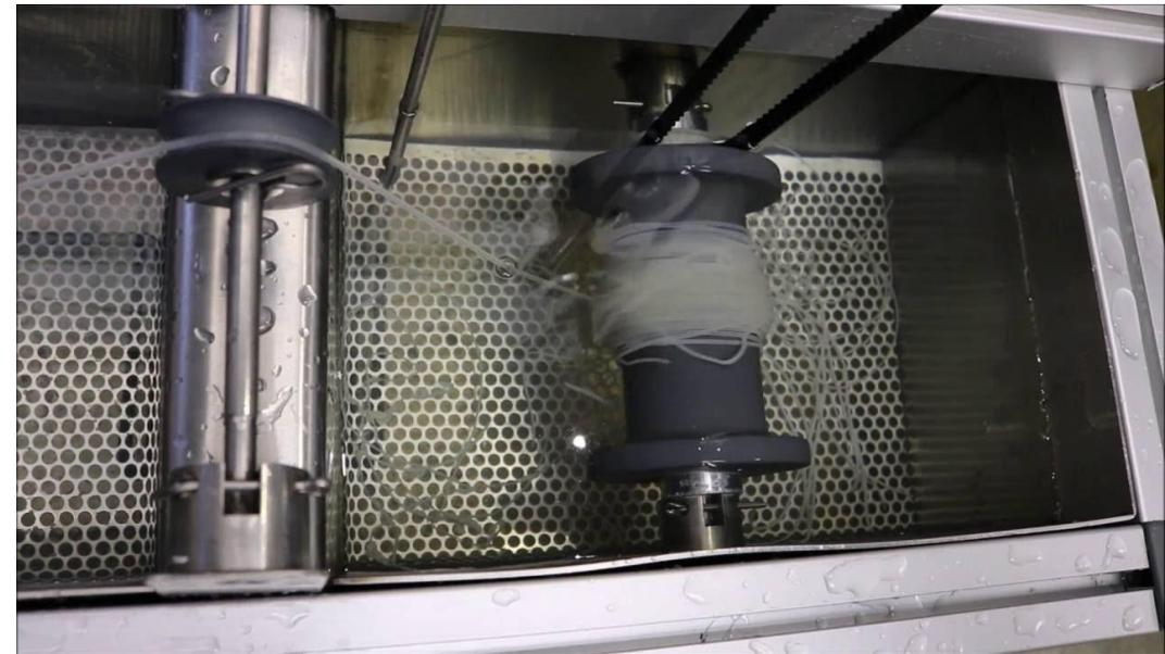
Fibra na saída da extrusora imersa em banho de coagulação.
