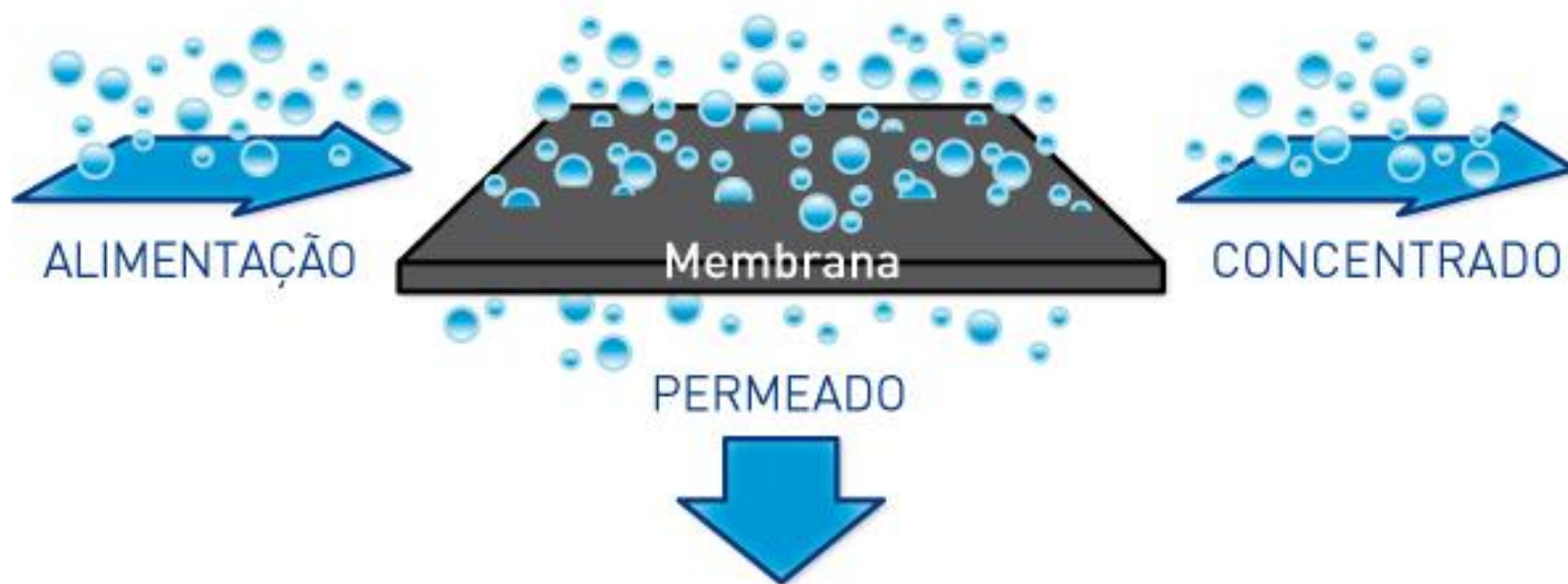
Figura: Representação do processo de separação por membranas com escoamento tangencial.
